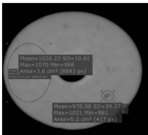
Рис. 3. Показатели РВТ области пониженной плотности и основной массы заряда
