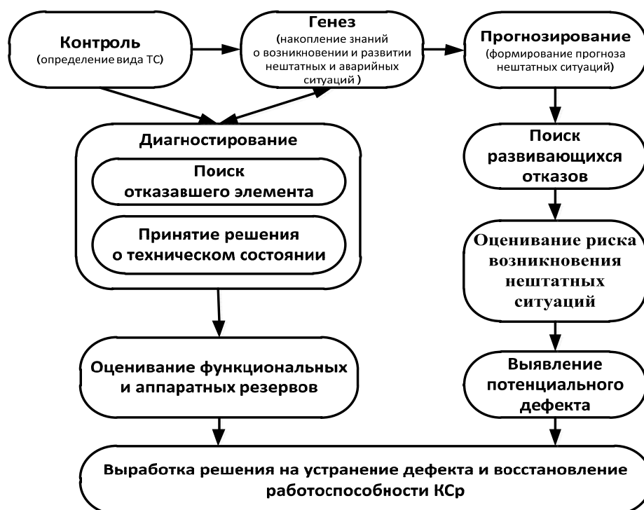
Рис. 1. Схема выработки решения на управление ТС КСр
