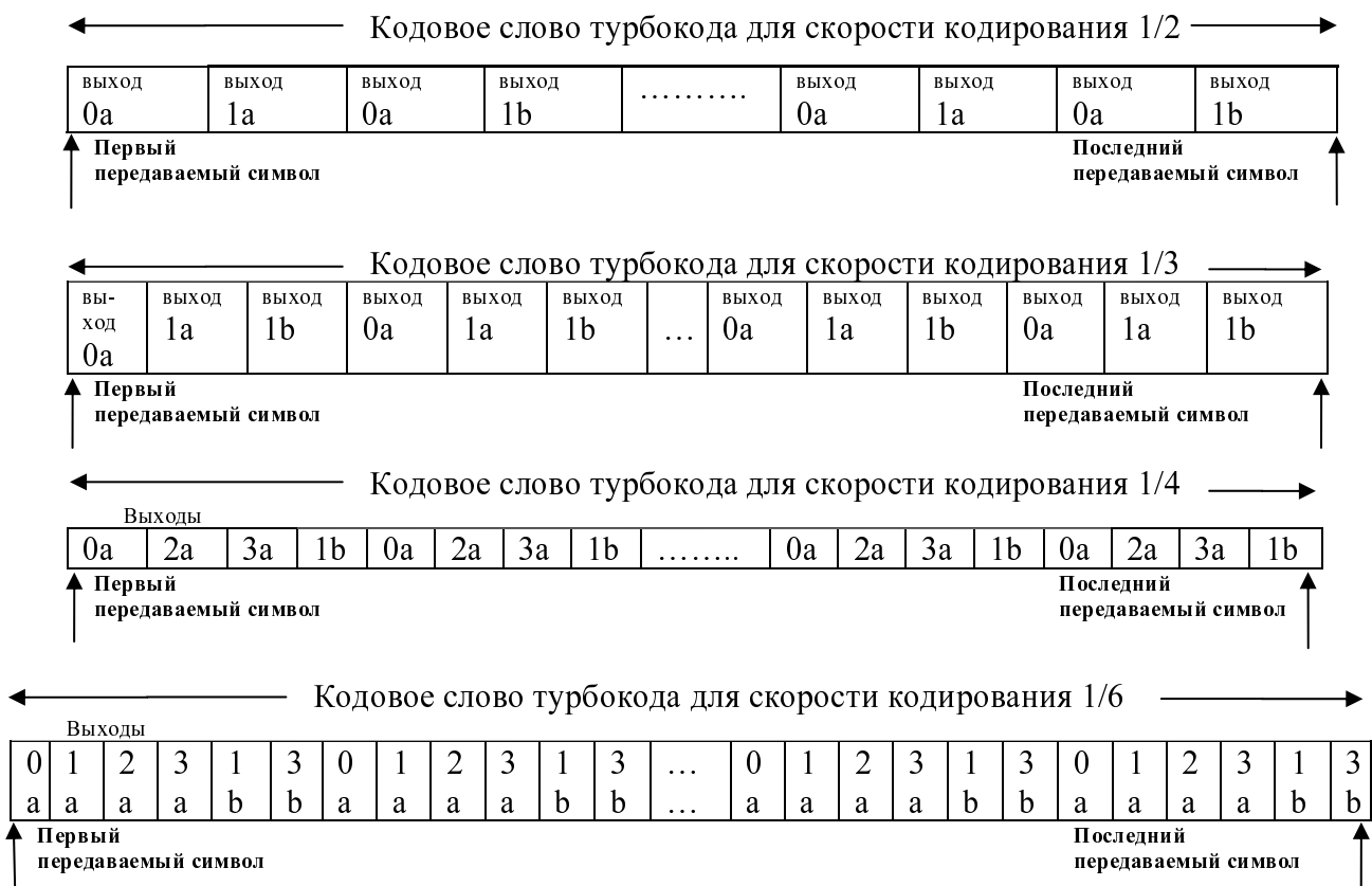
Рис. 3. Кодовые слова турбокодов для различных скоростей кодирования
