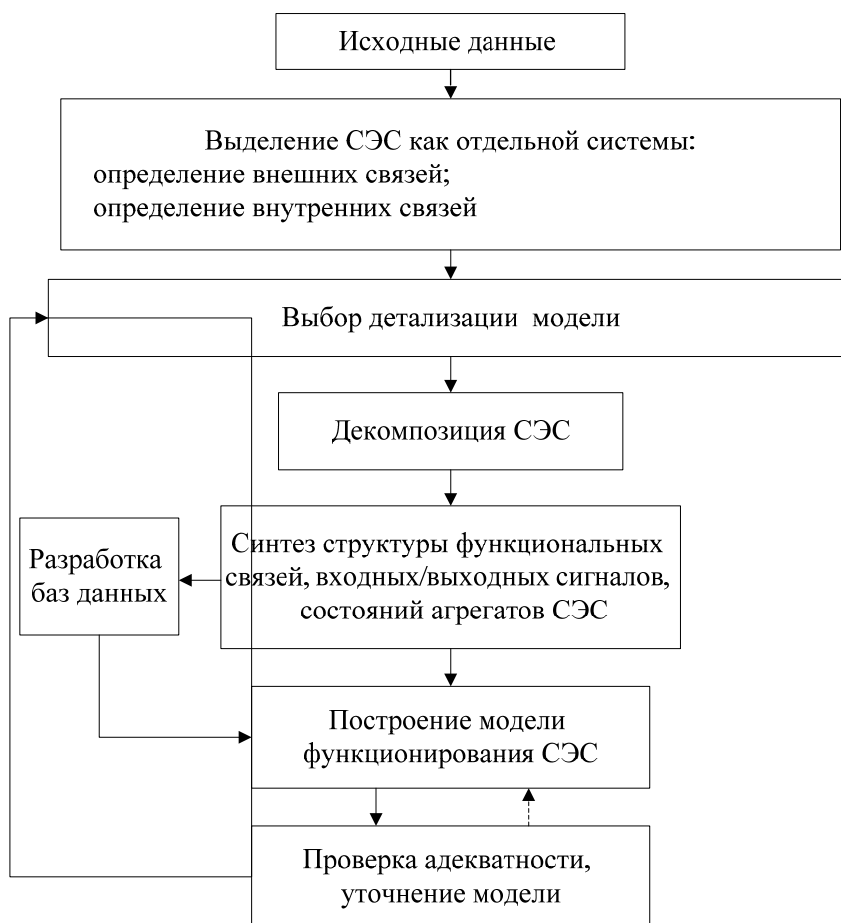
Рис. 1. Алгоритм концепции построения модели СЭС КА
