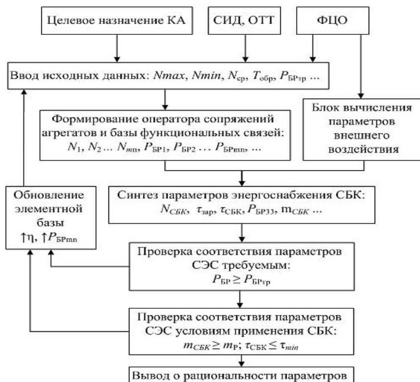
Рис. 8. Алгоритм обоснования рациональных параметров СЭС КА с СБК
