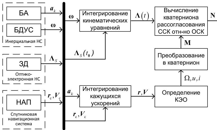
Рис. 1. Разомкнутая схема комплексирования информации в НС
