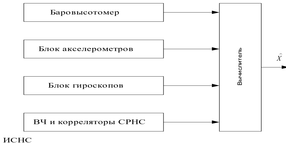
Рис. 5. Вариант «тесно связанного» комплексирования
