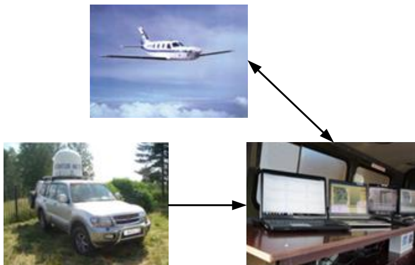
Рис. 8. Функциональная схема мобильного пункта управления работами по АВ на облака
