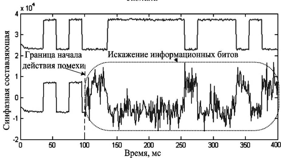
Рис.11. График зависимости синфазной составляющей принятого сигнала от времени для «совпадающей» копии кода
