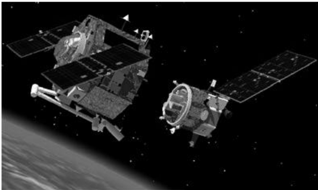
Рис. 4. Внешний вид КА системы «Orbital Express», слева – КА «ASTRO» справа – КА «NextSat»
