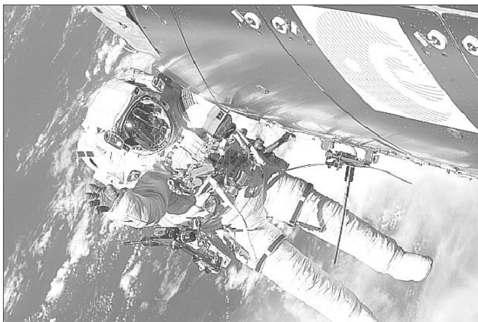
Рис. 1. Установка антенны АИС на модуле Columbus астронавтом Р. Бресником 21.11.2009г. (фото ЕКА, НАСА с сайта https://directory.eoportal.org )
