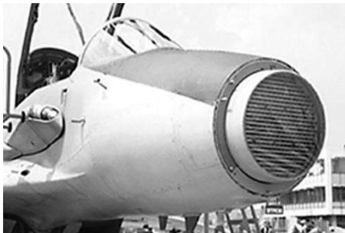
Рис. 1. Внешний вид АФАР бортовой РЛС X-диапазона типа «Жук» истребителя МиГ-35
