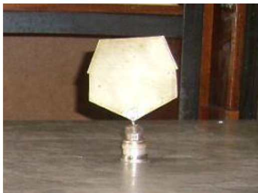
Рис. 11. Макет синтезированной антенны и ее КСВ в диапазоне частот относительно 50 Ом
