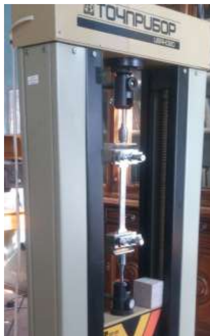
Рис. 2. Установка ИР 5113-100 с установленным плоским образцом
