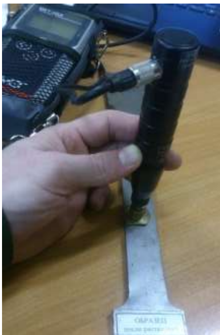
Рис. 1. Измерение твердости образца с помощью твердомера МЭТ-УДА и ультразвукового датчика У1
