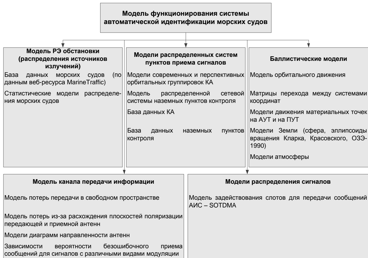
Рис. 1. Состав модели функционирования системы автоматической идентификации морских судов
