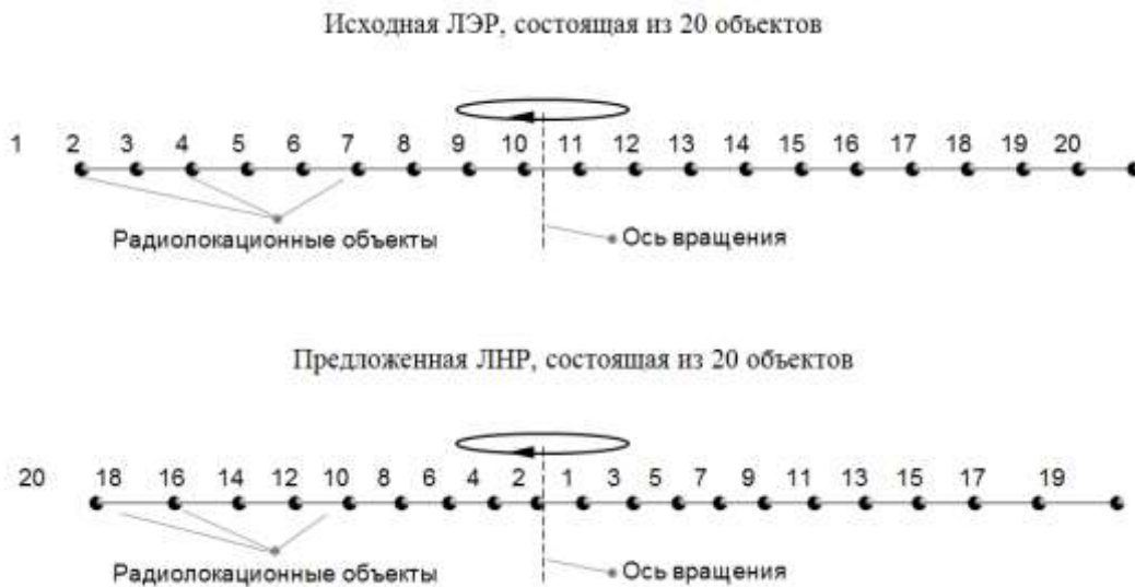
Рис. 4. Пример формирования ЛЭР и ЛНР, состоящих из 20 объектов и имеющих одинаковые линейные размеры
