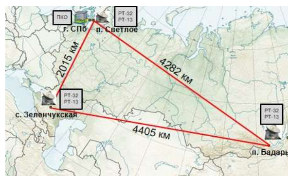
Рис. 1. Радиоинтерферометрический комплекс «Квазар-КВО»
