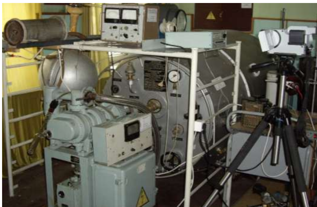
Рис. 2. Экспериментальный стенд для исследования температуры поверхности криогенного трубопровода:
