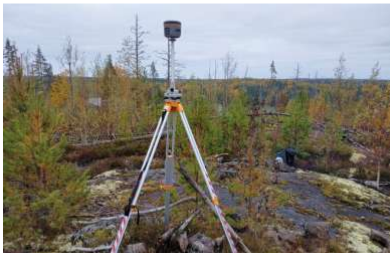
Рис. 2. Статические измерения на пункте ГГС Таусъярви в 113 км от места установки БС (СМТ-5) с использованием South Galaxy G1 Plus с IMU
